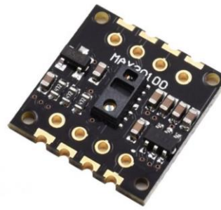
Fig. 2. MAX30100 Sensor (Pulse Oximeter).
