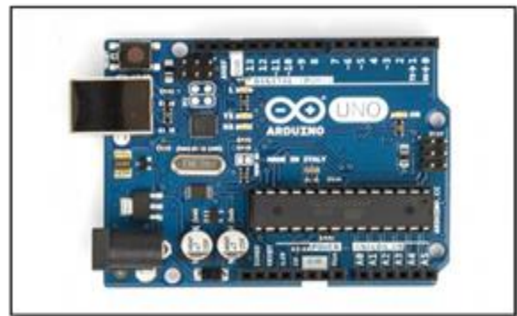
Fig.2 Arduino UNO board
